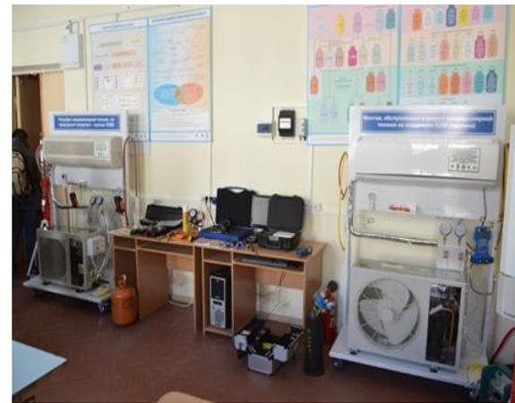
Основу учебного класса составляют три стенда бытовых систем кондиционирования типа сплит-система. Один из них демонстрирует сплит-систему фирмы Godrej (Индия) в заводском исполнении, хладагент – пропан. Это первая такая установка, смонтированная в Республике Беларусь и созданная в учебных целях. Учебный класс укомплектован оборудованием, приборами, комплектующими, инструментами, а также материалами для работы по обслуживанию систем на углеводородных хладагентах.
